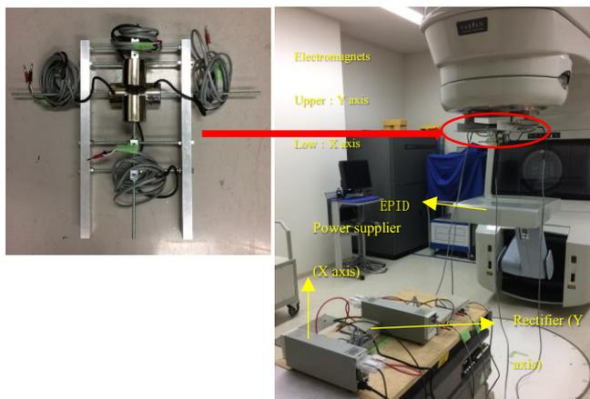
電磁石を用いた電子線の偏向による画像取得装置の開発
