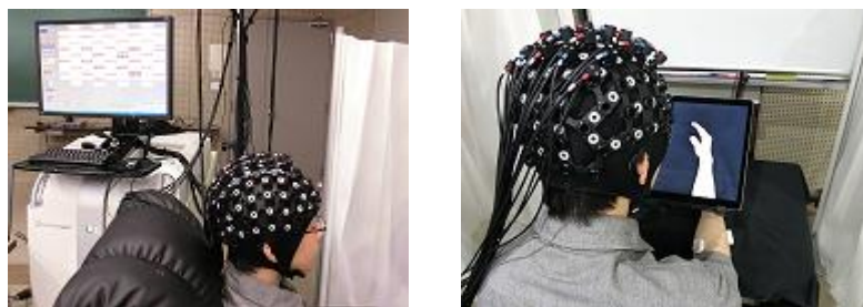
fNIRS を用いた視覚誘導性運動錯覚課題中の脳血流量の測定
